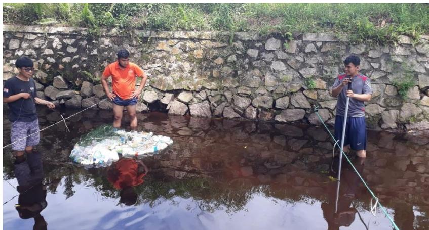
**Gambar 1** Pengukuran penampang memanjang dan melintang saluran serta pengukuran kecepatan aliran dengan *current meter*.
