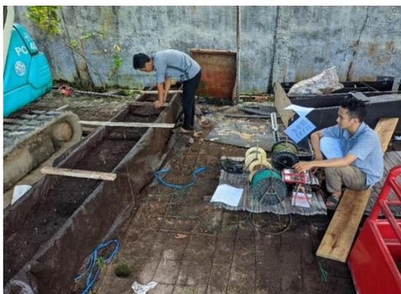
**Gambar 3.** Soil box beserta rangkaian alat yang digunakan
