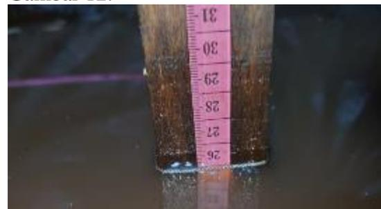
**Gambar 9.** Kondisi rambu ukur TMA hulu ketinggian air 25 cm
