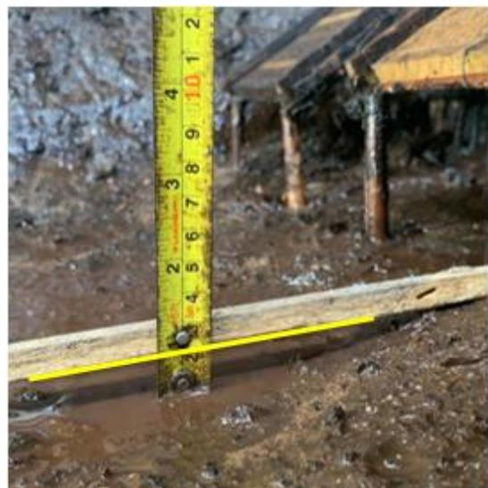
**Gambar 17.** Pengukuran kedalaman gerusan pada dasar saluran di bagian hilir model fisik sekat kanal.
