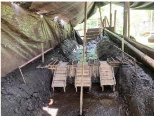
**Gambar 6.** Model fisik sekat kanal dan saluran
