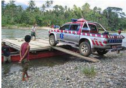
Gambar 6 Ponton dari rakit yang mengangkut mobil Sumber: id.wikibooks.org
