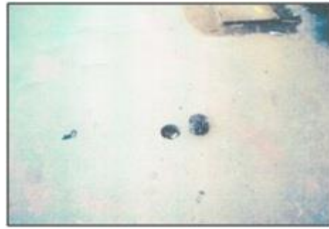
Pengambilan Sampel Lapis Permukaan dengan Cor Drill oleh Dinas PU
